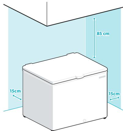
Instale o produto afastado de fontes de calor e livre da ação dos raios solares. Para garantir a circulação de ar, instale o produto respeitando as distâncias mínimas:
